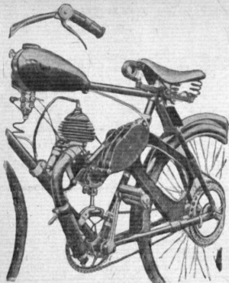
Рис. 3. Двигатель завода им. Энгельса в Ленинграде, который может быть поставлен на любой велосипед
